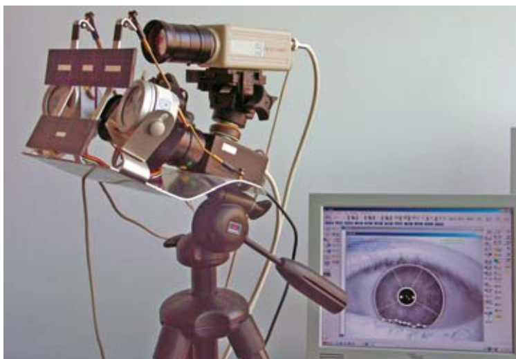
Prototyp systemu weryfikacji tęczówki
