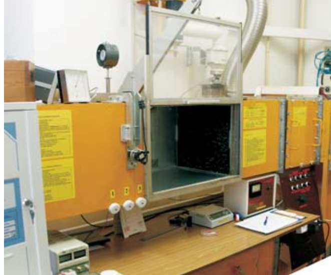
Widok kanału dymowego z otwartą komorą pomiarową
