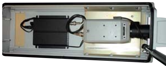
Obudowa z kamerą analogową i zainstalowanym serwerem wizyjnym
