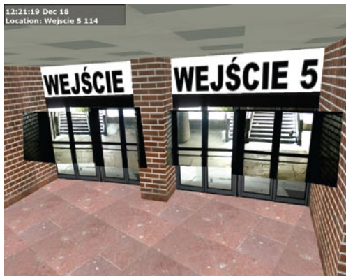
Wejście do obiektu, widok z 4 kamer naniesiony na model 3D
